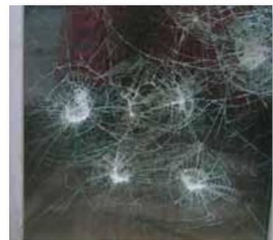
**GHP safe sr P2A** ist die geprüfte Folie mit dem Widerstandswert A1 nach DIN 52 290 und P2A nach EN 356 aus dem GHP-Programm (getestet auf 4 mm Einfachglas).
