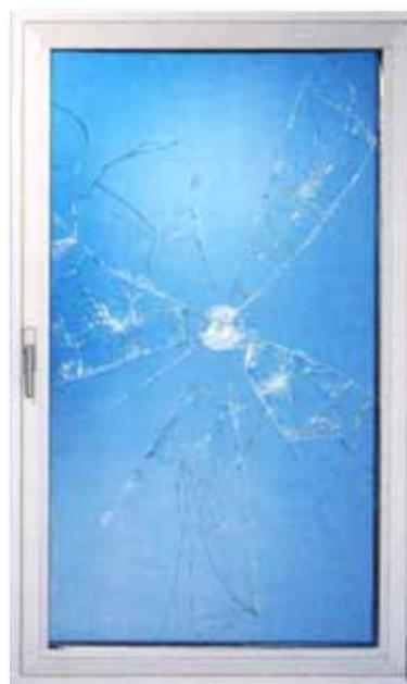
Bruchbild nach einem Steinwurf: GHP safe sr P2A bindet umherfliegende Splitter, das Glas bleibt im Rahmen.
